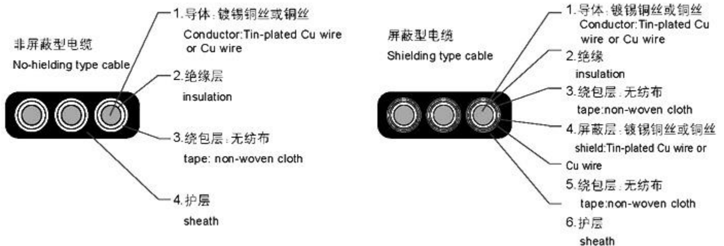
结构示意图 Schematic diagram of structure
